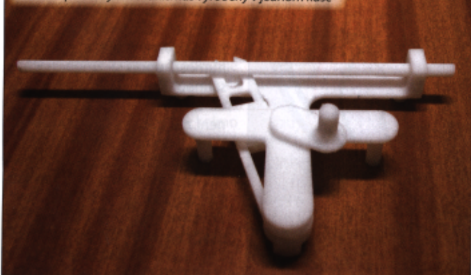
Funkční plastový mechanismus vyrobený v jednom kuse
